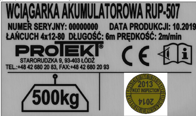
Rysunek 4 - Etykieta urządzenia wraz z naklejką inspekcyjną
